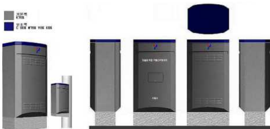
<그림 1> 모델 A 교통신호제어기 함체 외형
