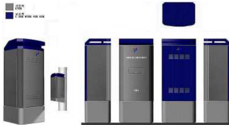
<그림 3> 모델 B 교통신호제어기 함체 (챙 모양 덮개를 부착한 예시)
